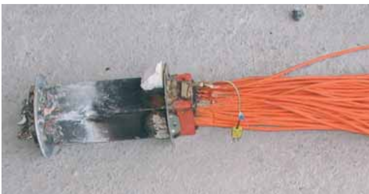
Dispositivo removido após 240 min de teste em fogo.
